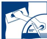
3. Estender a argamassa sobre a base, com o lado liso da desempenadeira e em seguida passar o lado denteado em ângulo de 60° para formar os cordões de assentamento.
