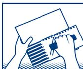
4. Em assentamento onde a necessidade de executar a técnica de \*dupla, camada aplicar argamassa também no verso da peça, e assentá-las de forma que os cordões fiquem paralelos aos cordões estendidos na base. Devolver a argamassa aderida na desempenadeira ao recipiente, misturar SEM ADICIONAR ÁGUA e utilizar novamente.
