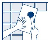
5. Colocar a peça pouco antes da posição final e arrastá-la até a posição desejada, apertar com as mãos e bater com martelo de borracha sobre toda a peça para esmagar os cordões da argamassa.
