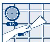
7. Limpar as juntas após o assentamento das peças removendo o excesso de argamassa para facilitar o rejuntamento. Proteger a área do sol, chuva e vento por 72 horas. Após este período o rejuntamento poderá ser realizado.
