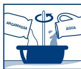
1. Em recipiente de plástico ou metal limpo e seco, misturar o produto de forma manual ou mecânica com água limpa até formar uma massa pastosa, firme e sem grumos secos. Trabalhar com o produto ao abrigo de sol, vento e chuva, para não interferir no tempo de pote da massa. **NÃO ADICIONAR NENHUM COMPONENTE ALÉM DE ÁGUA.**
