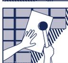
Assentar a peça e arrastar até a posição final, apertar com as mãos e bater com martelo de borracha sobre toda a peça para esmagar os cordões da argamassa. A junta entre as placas deve ser no mínimo de 2 mm.
